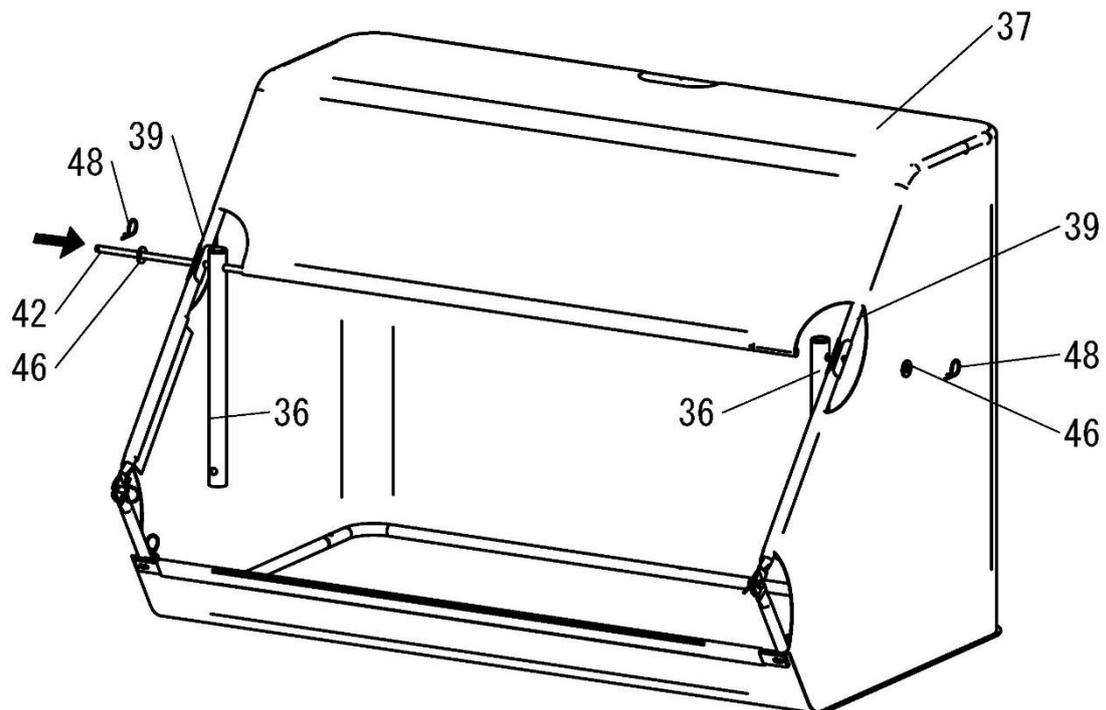
13.テンションチューブASY (41) の蝶ネジを外し、ホッパーバックを開いたままテンションチューブをホッパーバックの開口部からボトムフレームチューブの穴に慎重に差し込み、トップフレームチューブをテンションチューブの上に引っ張り上げ、穴を合わせます
