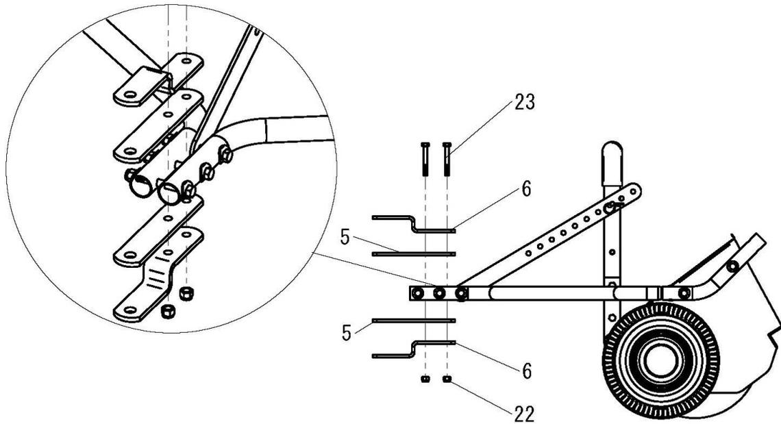
7. ボトムフレームチューブ (38) をリアフレーム (40) に差込み取り付けます
