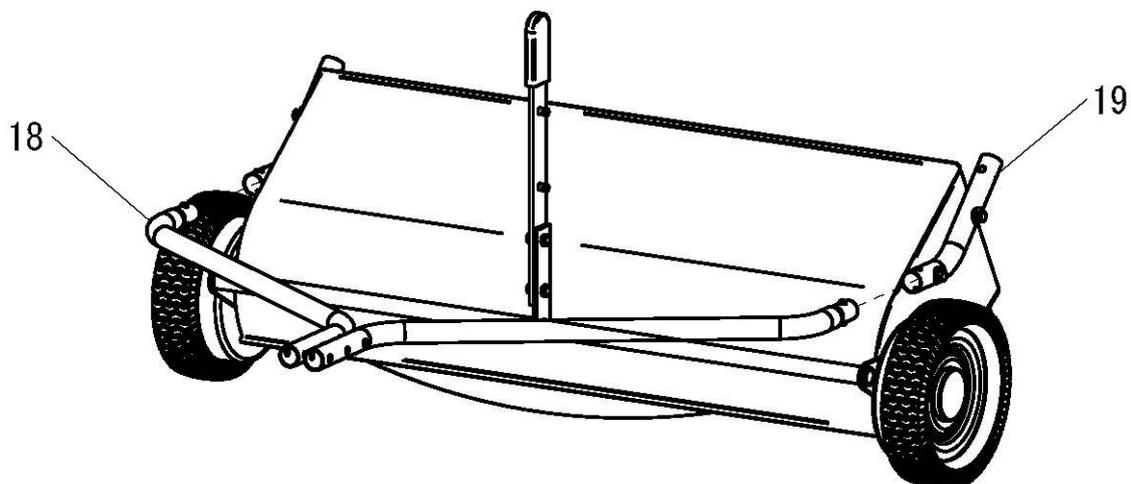
4. 図のようにヒッチチューブの前側2カ所にボルト（25）を通し固定します
