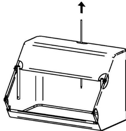
6. 調整レバーを外し、ヒッチチューブを本体から外せば、コンパクトに保管できます。
