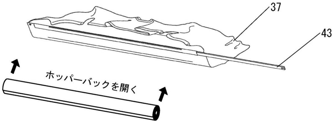
9. 最初に、ボトムフレームをホッパーバックの中に入れ、図のようにホッパーバーとボトムフレームをクレビスピンとヘアピンで固定します
