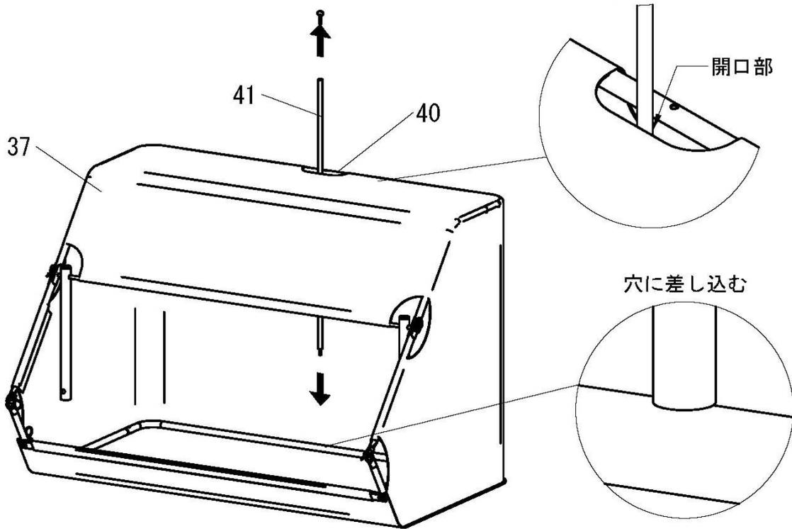
14.テンションチューブASYに付属していた蝶ネジでトップフレームチューブとテンションチューブを合わせた穴より固定します
