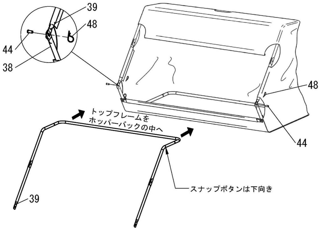
12. ピボットロッド (42) をトップフレームチューブ→コネクティングチューブ (36) の順に通し、次にホッパーバックのポケットに通します
