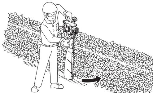
1. エンジン始動後スロットルトリガを高速の位置にスライドさせると、エンジンの回転速度が上がり刈刃が動き始めます。
